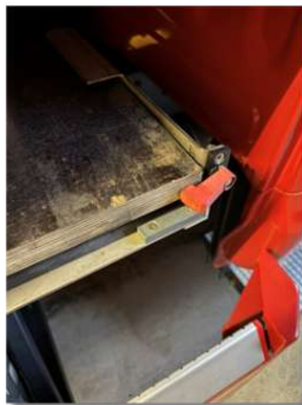
Loquet défectueux sur un véhicule modulaire
